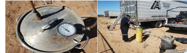
13.- DETECCION DE POSIBLES FUGAS EN LAS PUERTAS DEL EMBARQUE Y CONEXIONES DE MANGUERAS CON EL DETECTOR DE HALUROS ELECTRONICO
