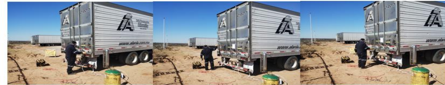
13.- DETECCION DE POSIBLES FUGAS EN LAS PUERTAS DEL EMBARQUE Y CONEXIONES DE MANGUERAS CON EL DETECTOR DE HALUROS ELECTRONICO
