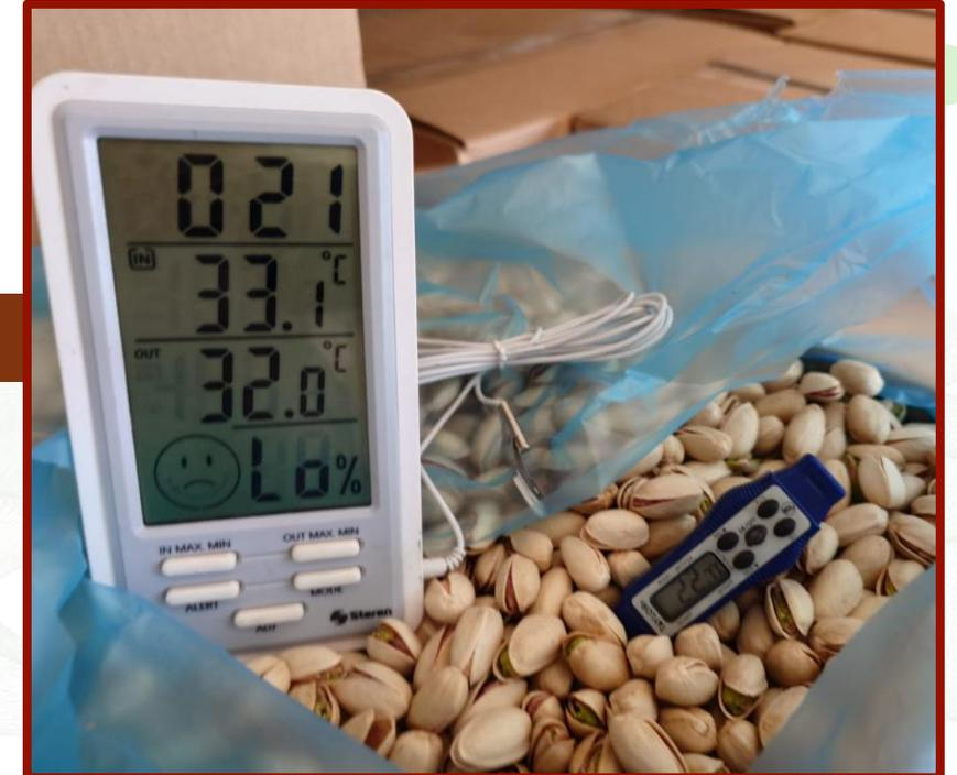
El operario utiliza el Termómetro digital y el Higrómetro
