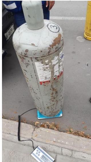
d. El periodo de exposición inicia al término de la inyección del BM, éste se deberá inyectar en estado gaseoso, con el uso del evaporador que deberá mantener una temperatura igual o mayor a 65°C.
